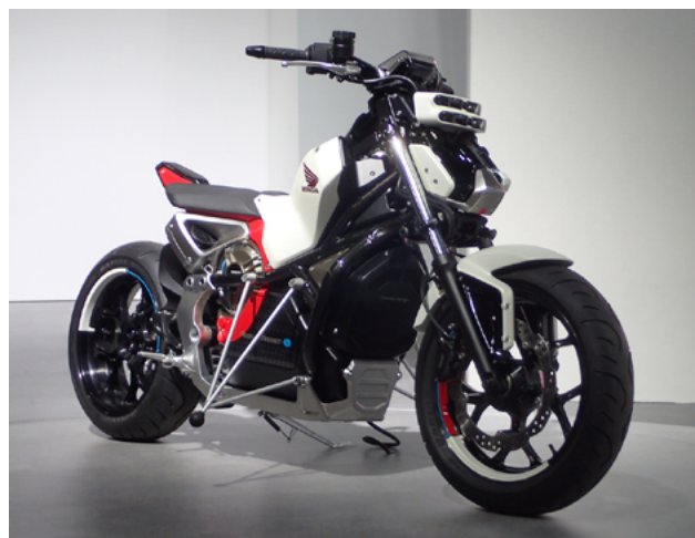
写真 17 HONDA 二輪のEV、極低速走行時にはマシン自体がバランスを保つ。
