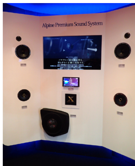
写真 15 Alpine はスピーカーのコーン紙の素材にナノセルローズを採用。
