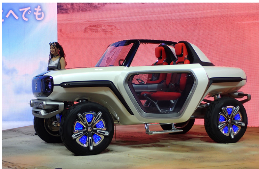
写真 18 SUZUKI のコンセプトカーはモーター4ヶ、4 駆のEV。
