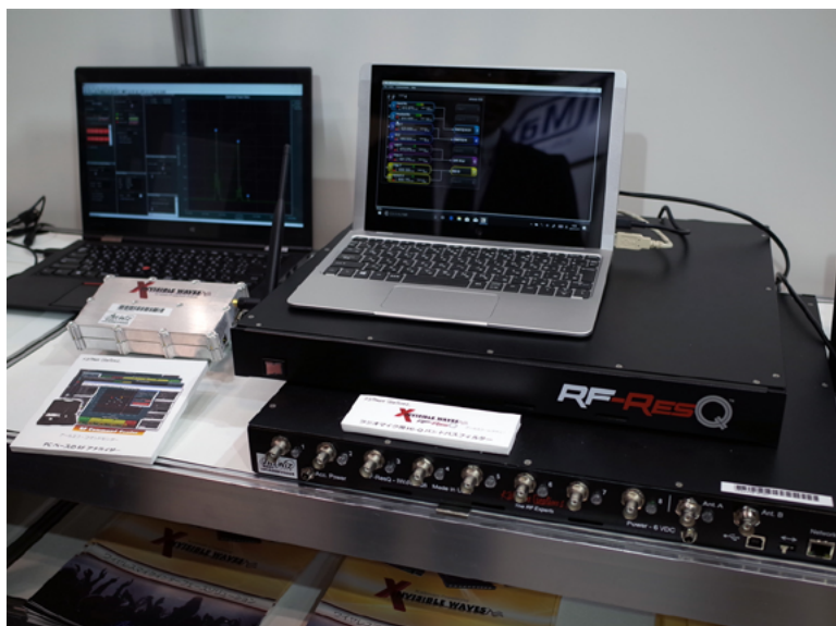
写真17 ラジオマイクが混雑する展示会や催事場などで各 ch ごとにフィルターをかけ1Uで8ch使用できるバンドパスフィルター。飛び入りの武藤でした。
