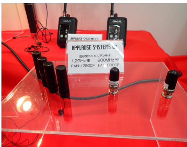
写真10 (株)キャッチミー ブースでは超小型のヘリカル アンテナを展示、TV カメラや報道の仕込みなどでご 採用との事、PA チームでも使い易いのでは。
